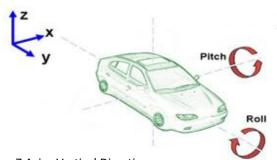
Z Axis : Vertical Direction X Y Axes : Horizontal Direction
